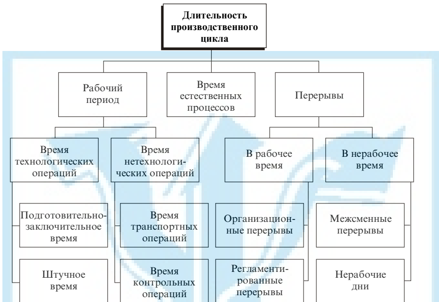
Рис. 8. Структура производственного цикла
