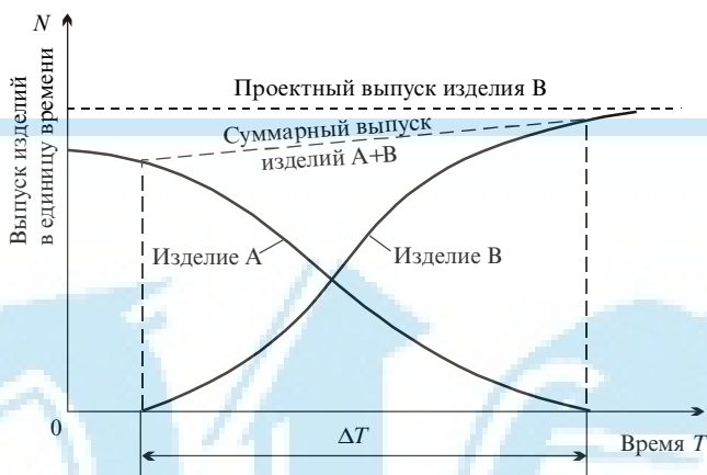
Рис. 31. Параллельный метод перехода на выпуск новой продукции
