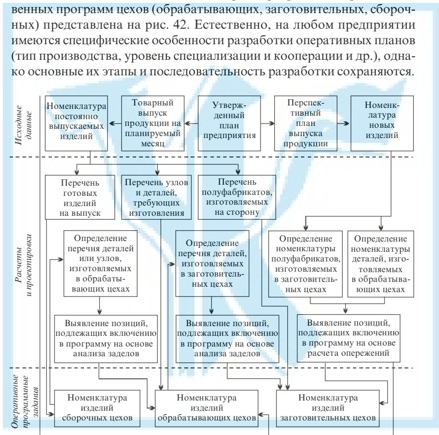
Рис. 42. Последовательность этапов установления номенклатуры изделий, подлежащих включению в оперативные программы цехов
