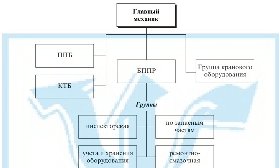
Рис. 14. Структура отдела главного механика на крупном предприятии: ППБ — планово-производственное бюро; КТБ — конструкторско-технологическое бюро; БППР — бюро планово-предупредительных ремонтов
