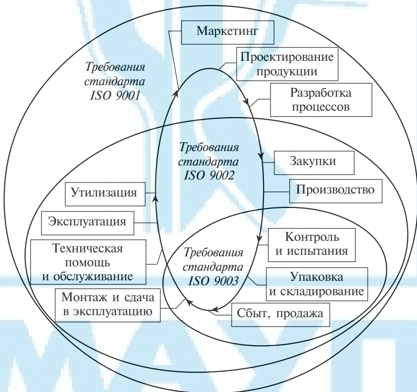
Рис. 19. Стадии витка качества, охватываемые системами качества по стандартам ISO 9001, ISO 9002 и ISO 9003
