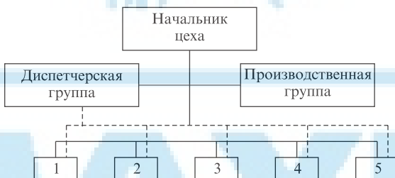
Рис. 19. Схема управления цехом безрельсовых транспортных средств. Участок: 1 — автомобилей и тракторов; 2 — электротранспорта; 3 — погрузочно-разгрузочных механизмов; 4 — ремонтный; 5 — дорожно-путевой
